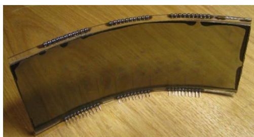
Экспериментальный образец неплоской оптической части ЛАСФ (цилиндрической формы)
